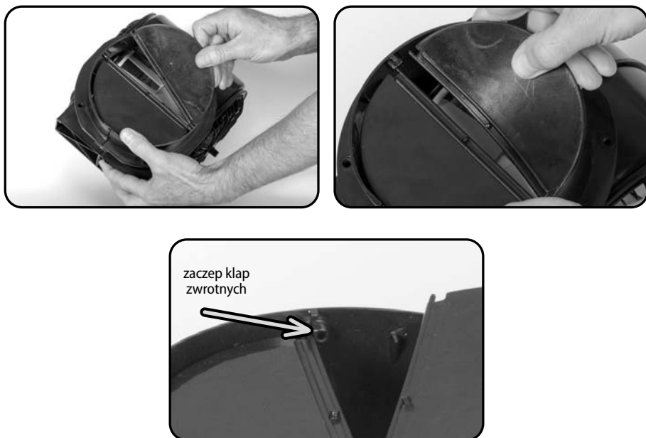
Ryc. 4. Montaż klap zwrotnych na wylocie turbiny
